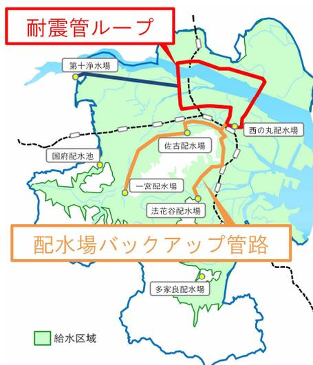
図 3.4 耐震管ループと配水場バックアップ管路
